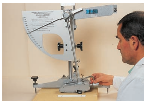
Essai SRT: pendule « Skid Resistance Test ».
