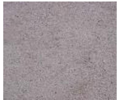
*Détail d'un sable rose stabilisé à l'aide d'un liant hydraulique routier spécifique.*
