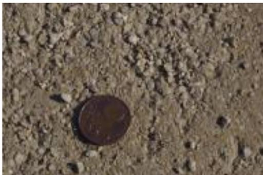
Détail d'une grave naturelle stabilisée à l'aide d'un ciment.
