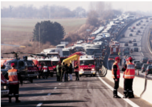
Le dispositif de sécurité en béton a limité l'accident à un seul sens de circulation.
