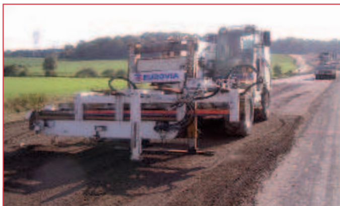
OLIVIA® : la machine de préfiissuration d'EUROVIA.
