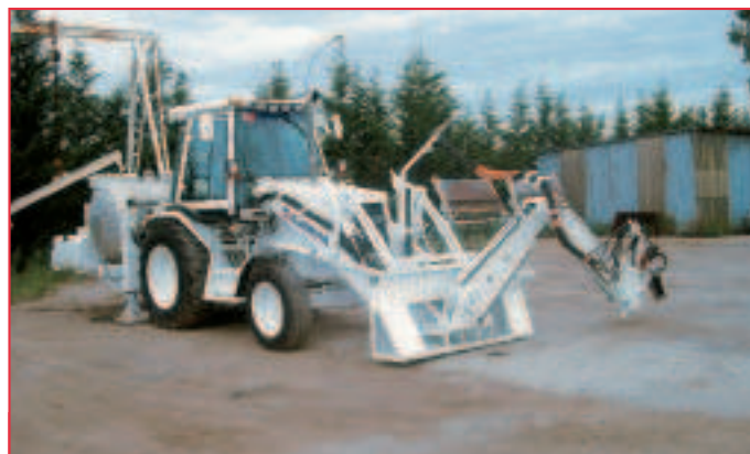
Procédé CRAFT® : le soc, porté par un bras télécommandé, permet d'ouvrir un sillon dans la grave-ciment.
