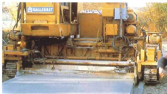
Mise en œuvre à la machine à coffrage glissant.
