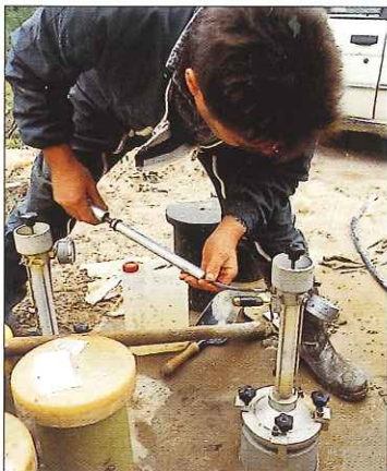
L'air incorporé dans le béton de sable accroît sa maniabilité. Une mesure permet de s'assurer que la teneur en air occlus est comprise entre les 7 à 8 % requis.
