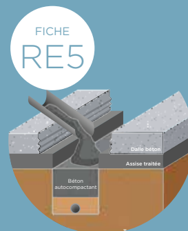
REMBLAYAGE PAR UN MATÉRIAU AUTO-COMPACTANT
