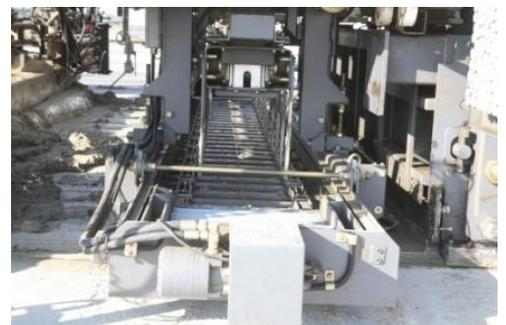
Figure 12- Dispositif à l'arrière de la MCG pour introduire les goujons dans le béton frais
