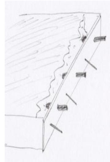
Figure 42- Schéma du coffrage d'un joint transversal de construction (fin de journée)
