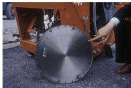
Figure 110- Disque de sciage diamanté
