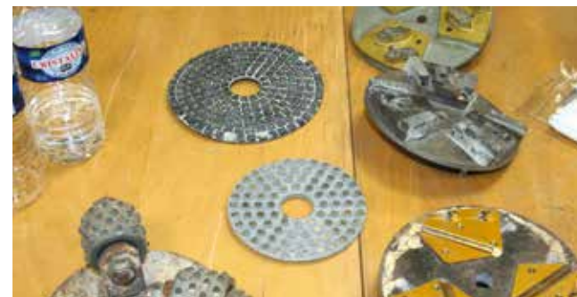
Outils : boucharde / disque / squamage / ponçage ©Specbea
