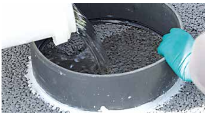
Mesure de la drainabilité ou de la vitesse d'infiltration
