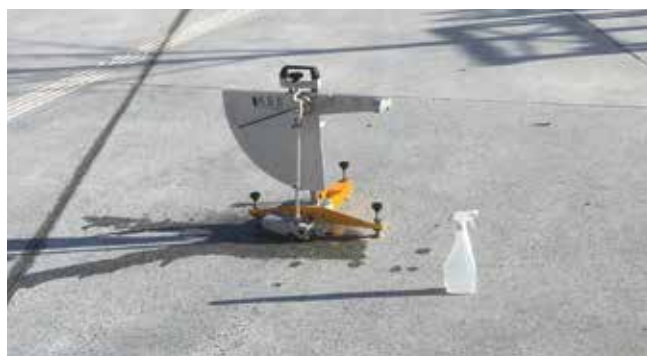
Pendule SRT : mesure de la micro-rugosité. ©Signal Expertise
