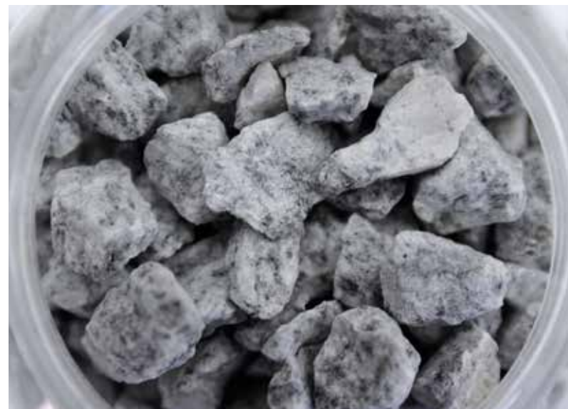
Exemple d'échantillon de granulats ©Fenêtre sur cour
