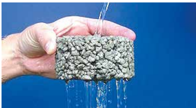
Revêtement drainant (l'eau traverse) ©CIMbéton
