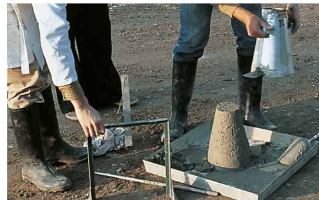
Essai au cône d'Abrams : béton de consistance de classe S2 ©CIMbéton
