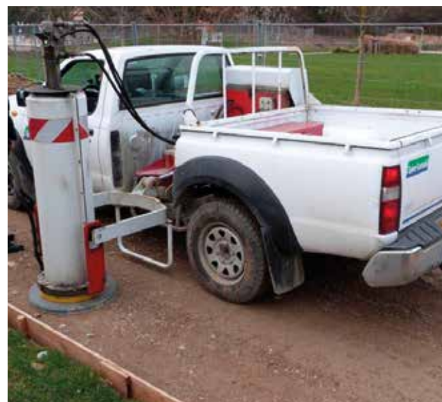
Essai de portances à la Dynaplaque, Parc des Chanteraines, Hauts-de-Seine ©CIMbéton
