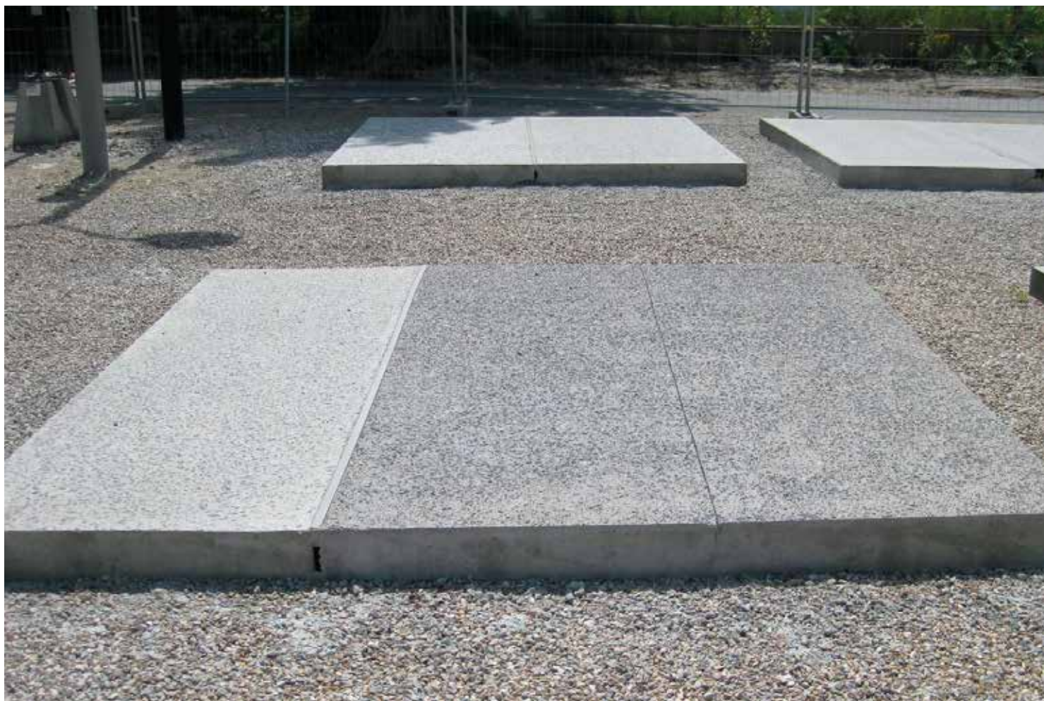
Planches d'essais pour le projet d'aménagement du parvis du Stade du Havre ©Mineral Service
