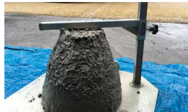
Essai au cône d'Abrams : béton de consistance de classe S2 ©EFCAT Sols Béton
